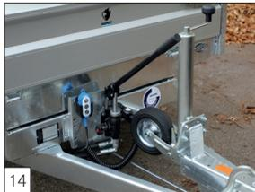
**Option:** Not-handpumpe bei Elektro-pumpe montiert (die abnehmbare Bedienungskasten inkl. verlängertem Spiral-Kabel ist serienmäßig bei Modellen mit Elektro Pumpe).
