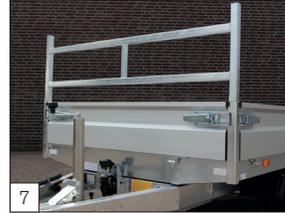
**Option:** abnehmbares Frontgitter montiert.
