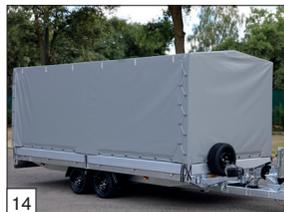
**Option:** Plane-und-Spiegel 180 oder 210 cm hoch. Die Spiegel-Konstruktion ist abnehmbar und modular aufgebaut.
