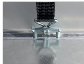
**En série :** système d'arrimage de chargement HAPERT certifié par TÜV : anneaux d'arrimage intégrés dans les côtés (1000 daN. par pièce).
