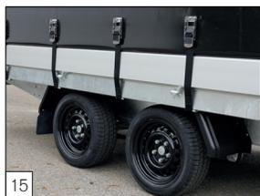
**Option :** les modèles Azure H avec essieux paraboliques ont des pneus 185 R14C, 185/70 R13C ou 195/50 R 13 avec des jantes noires.
