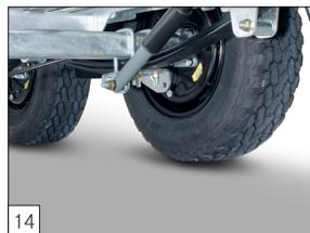
**Option :** les modèles Azure H en 3 500kg PTAC à partir de 335x180 sont livrable avec des essieux paraboliques avec amortisseurs. Les pneus 195/50 R13 ou 185/70 R13C sont avec des jantes noires.
